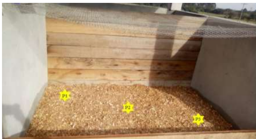
Figura 2. Pontos de aferição das temperaturas internas nas composteiras.
