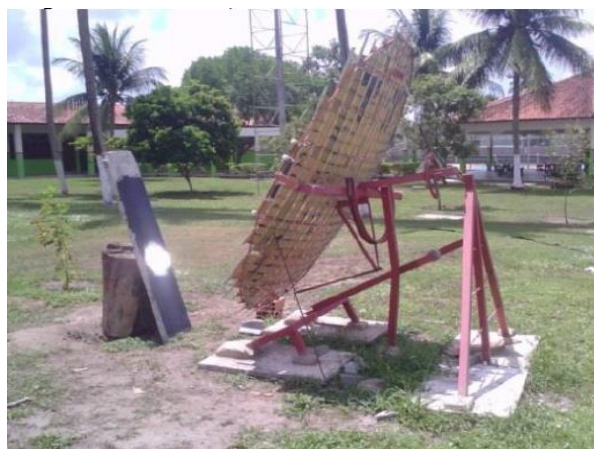
Figura 2. Posicionamento do bloco de concreto no foco do concentrador solar (CERQUEIRA; SANTOS, 2013)
